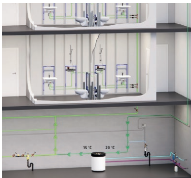
Bild 2: Beispiel einer Installation mit Ringleitungen und Kaltwasserzirkulation
